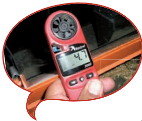
Вимірювальні прилади Вимірювання швидкості руху повітря, що надходить у пташник при подачі повітря, показує, чи є правильним негативний тиск вентиляції.
